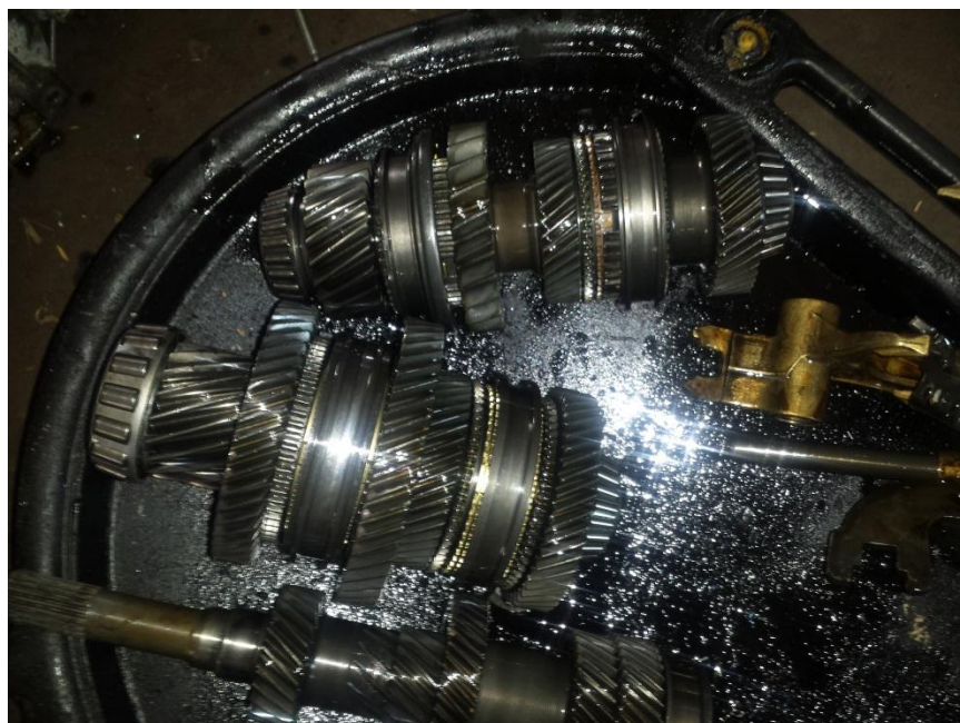
Obr. 4: Demontované hřídele z obuzenými koly a zubovými spojkami
