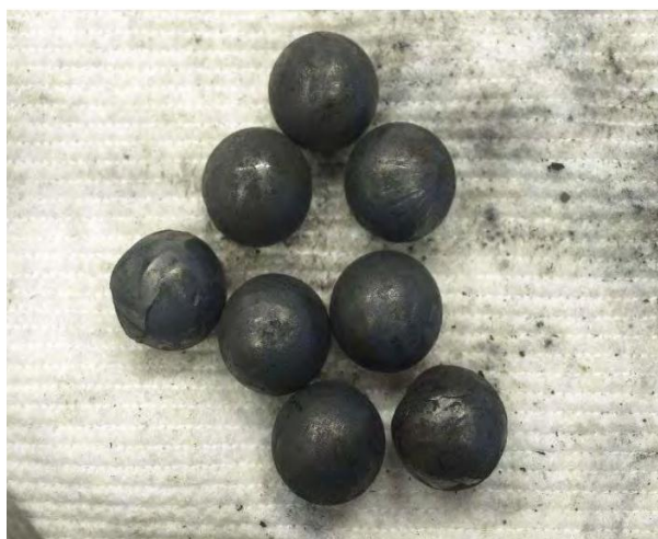
Obr. 4.21: Degradované mazivo – valivá tělíška [11]
