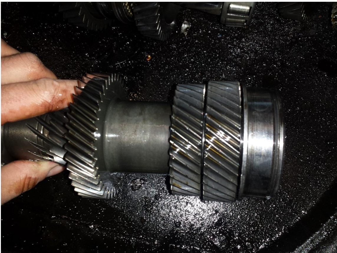
Obr. 4.5: Vstupní hřídel s poškozeným valivým ložiskem na konci
