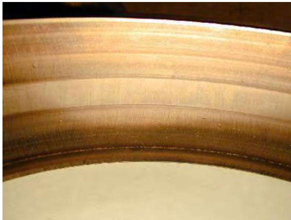
Obr. 4.22: Vydřené oběžné dráhy[11]
