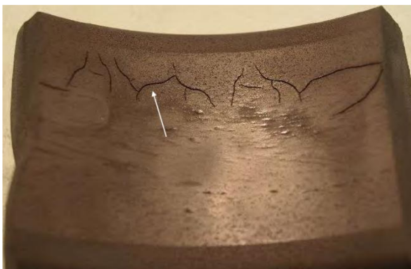
Obr. 4.15: Spálení povrchu ložiska – rozvoj trhlin 2[11]
