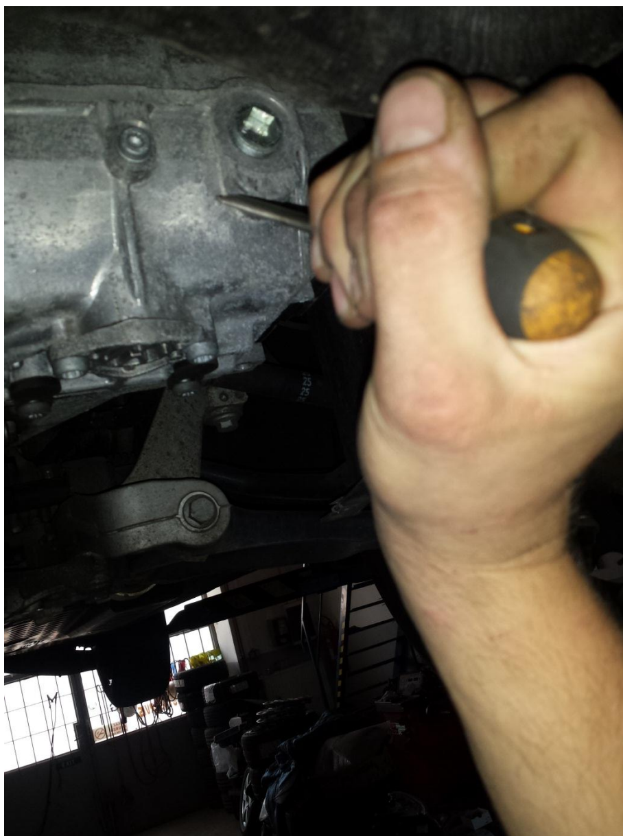
Obr. 7: Použití šroubováku jako vedení hluku a vibrací
