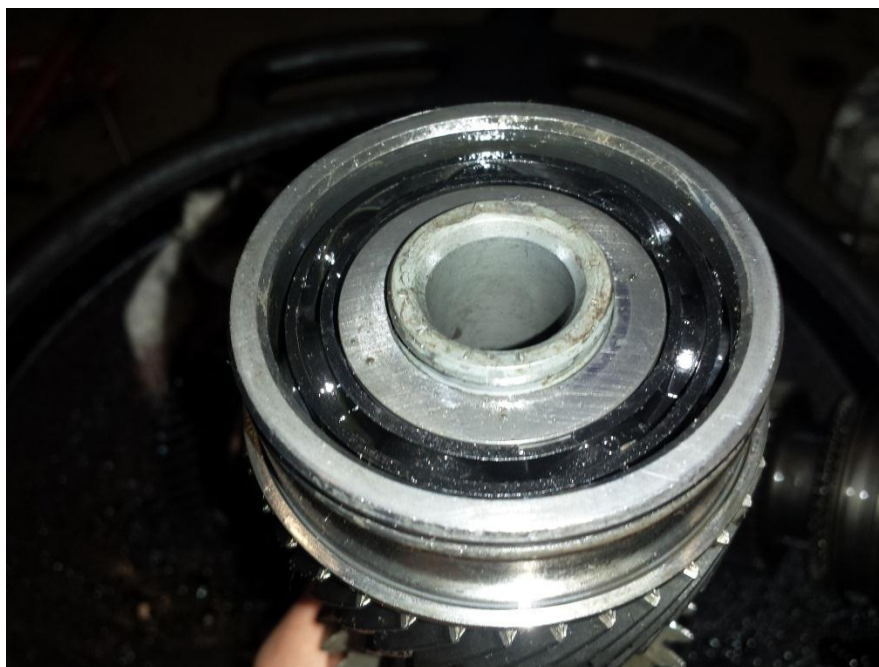
Obr. 6: Pohled na poškozené valivé ložisko
