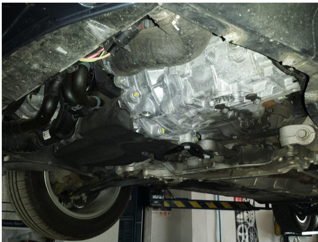
Obr. 4.2: Pohled na již vyměněnou převodovku
