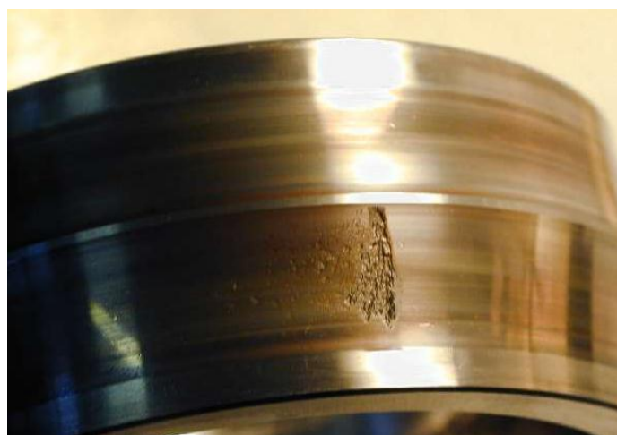
Obr. 4.23: Vydřené oběžné dráhy s rozvojem pittingu [11]
