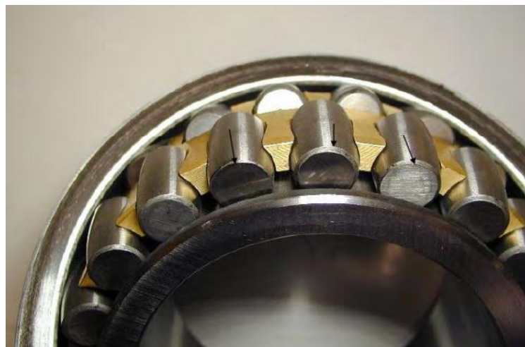
Obr. 4.17: Nesprávný tvar ložiska – rozdílné rádiusy [11]
