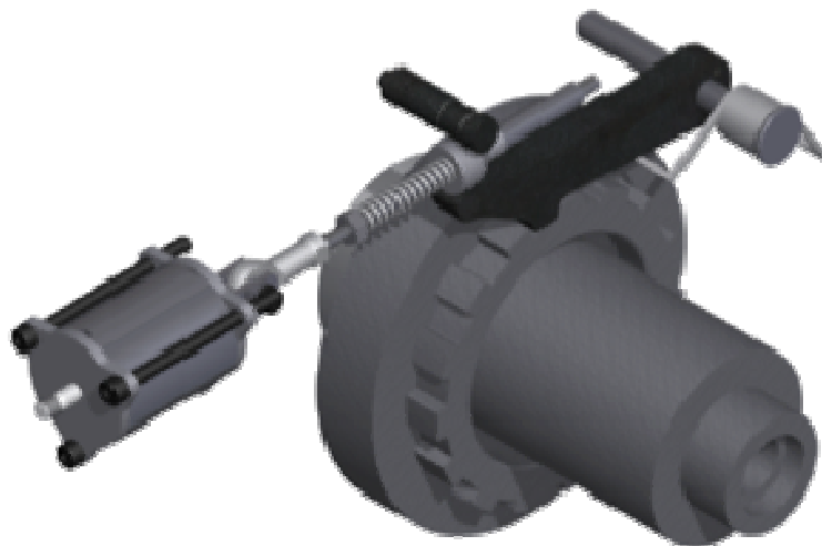
Obrázek 11 Řešení parkovací brzdy firmy Camcon-Automotive [6]
