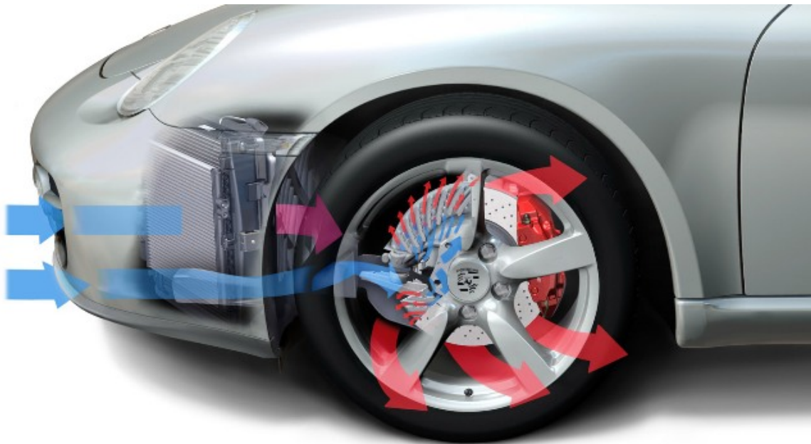
Obr. 18: Přívod vzduchu z čela vozidla [15]
