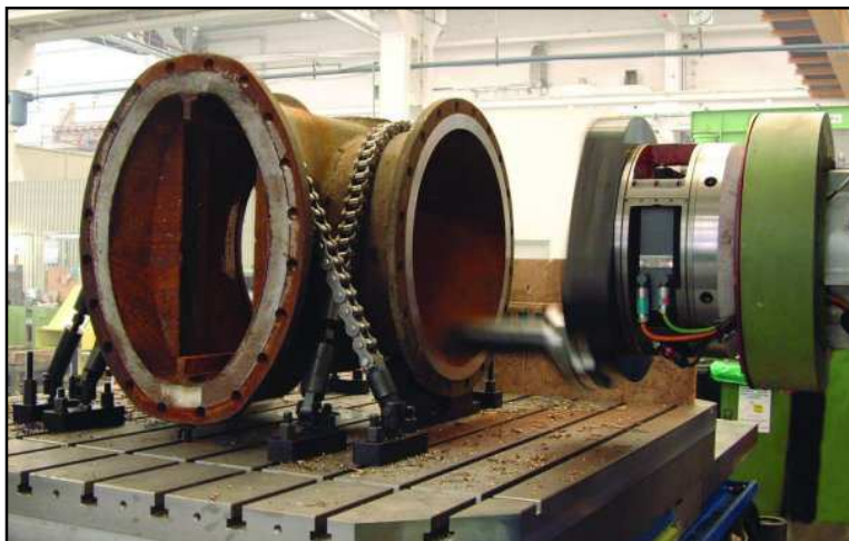
obr. č.2 Frézování čela ventilu
