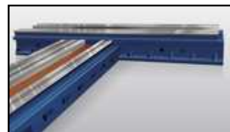
obr. č.17 Lože stolové horizontky.
