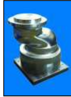
obr. č.6 a č.7 Frézování klikového hřídele hlubíného čerpadla z jednoho kusu
