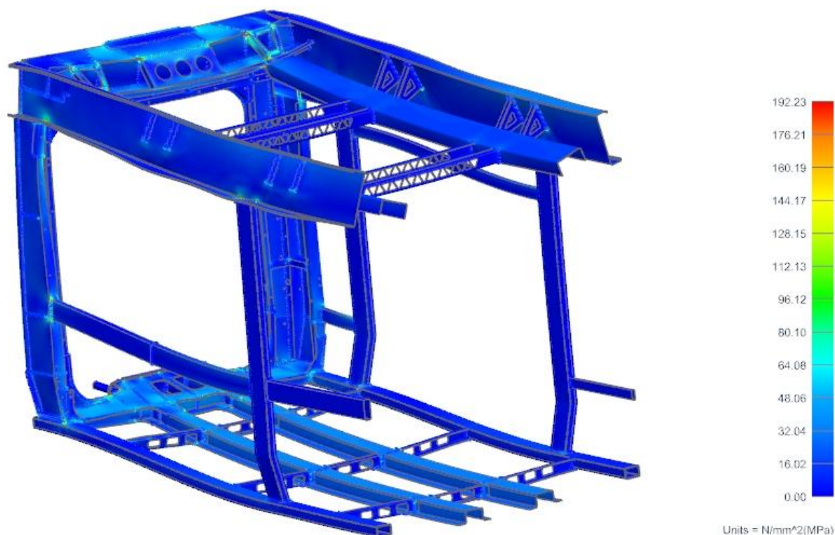
Obr. 54 Celkový pohled na výsledky napěťové analýzy pro celou sestavu s barevnou a číselnou stupnicí.
