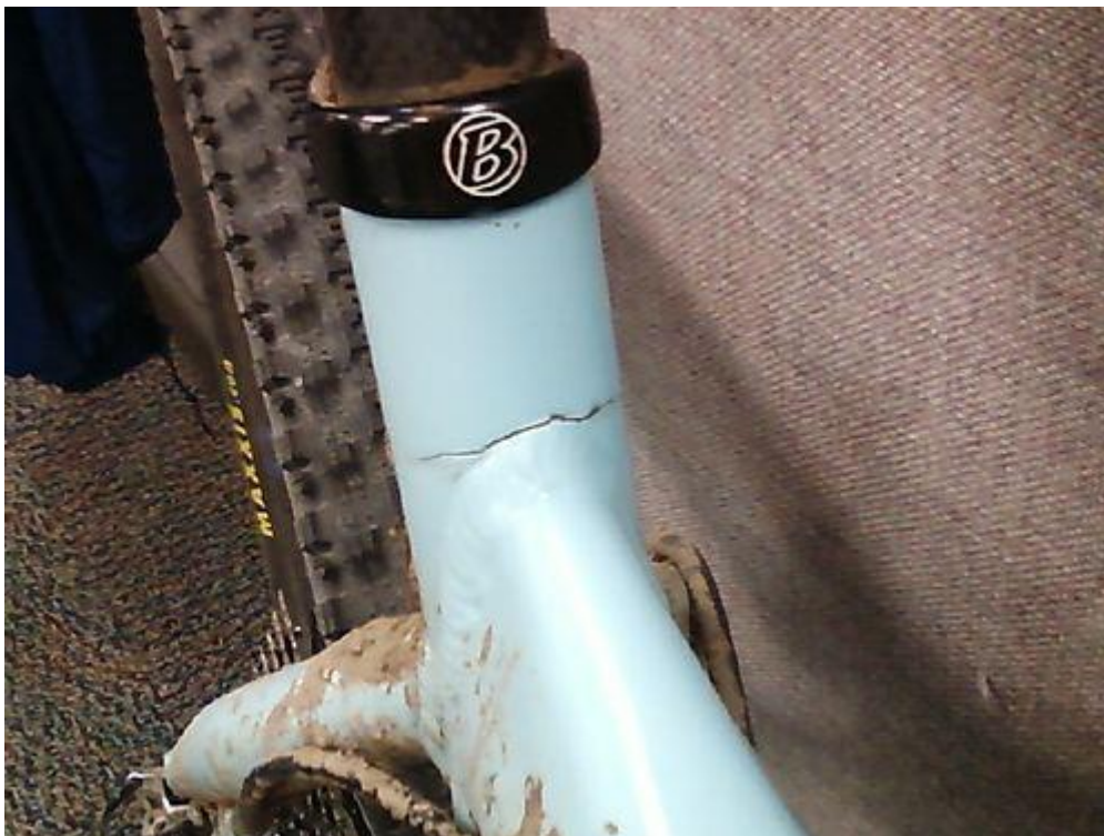
Prasklina rámu [25] zdroj:
