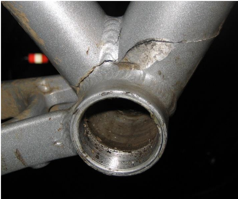
Prasklina rámu [26] zdroj: http://squarezero.org/blogpix/2007/crackXL.jpg
