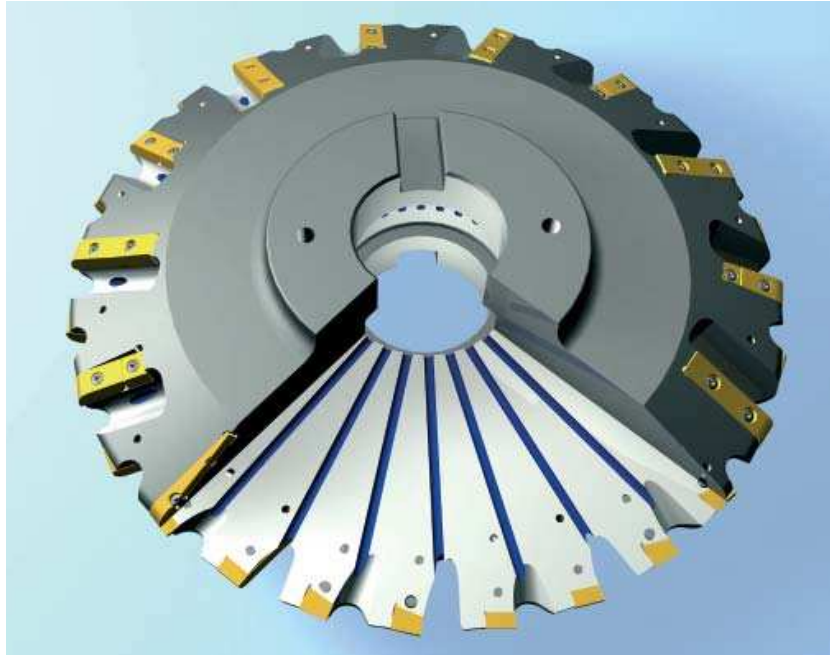
Obrázek 4-4: Tvarová fréza BP IV v řezu [24]
