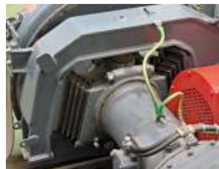
Obrázek 8: Detail vypružení Megii [6]
