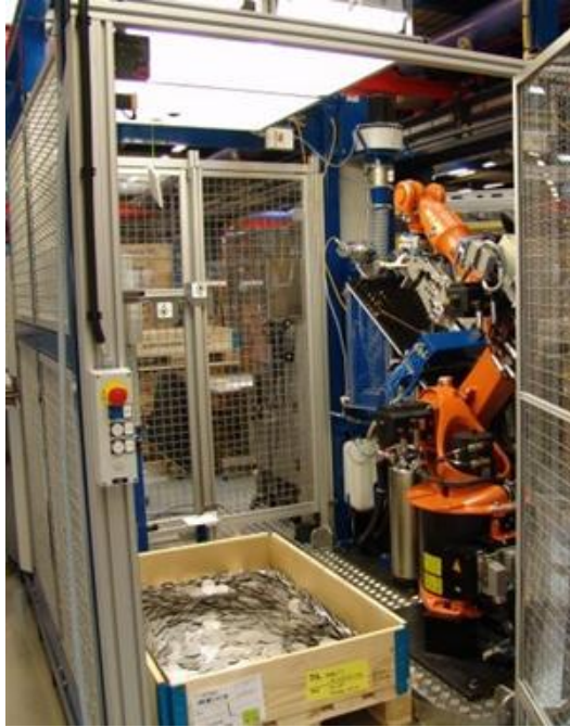
Obr. 5 - Zakrytované Bin-Picking pracoviště [3]
