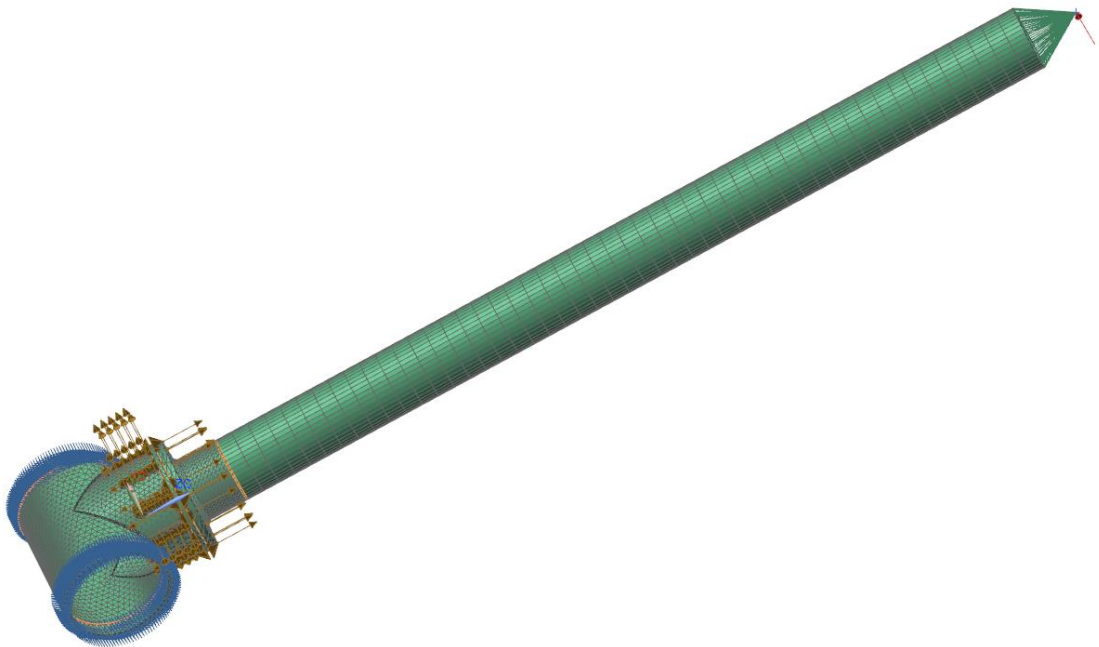
Obrázek 12-13 - Nastavení pevnostní analýzy nosné tyče řídítek
