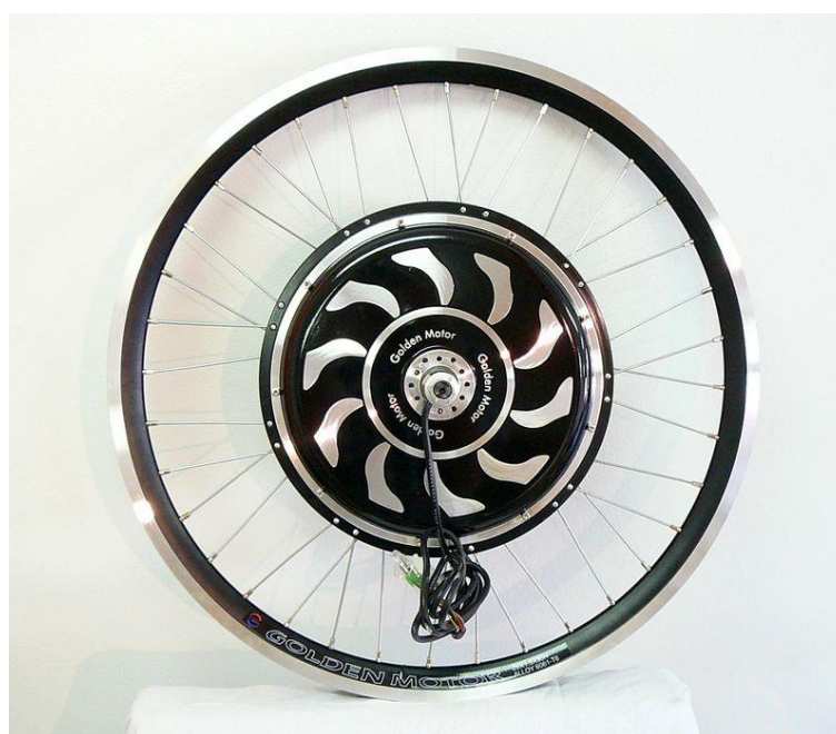
Obrázek 6-5 - Vestavěný elektromotor v kole o výkonu 500 - 1000 W v závislosti na velikosti napájení [11]
