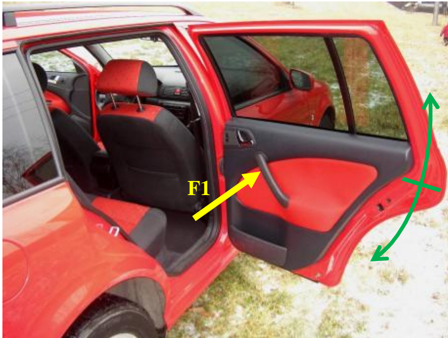
Obr. 1.1 - Boční dveře automobilu. F1 je znázorněna žlutou šipkou. Volný pohyb – Boční dveře automobilu. F1 je znázorněna žlutou šipkou. Volný pohyb pak zelenou obousměrnou šipkou.
