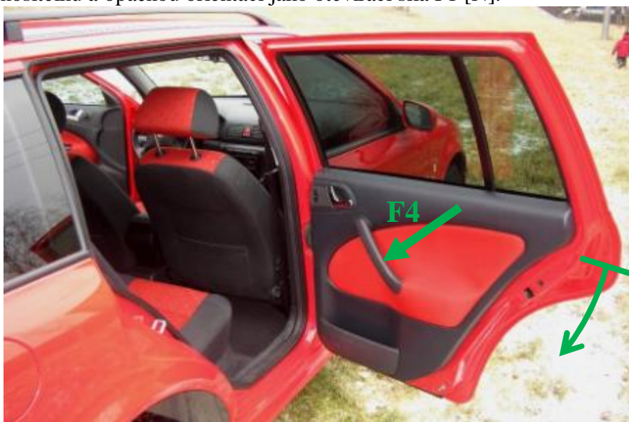
Obr. 1.4 – Zavírací síla F_4 [N] je zobrazena zelenou barvou a pohyb dveří zelenou šipkou.
