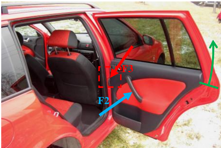
Obr. 1.3 – Síla F_2 [N] (modře) je síla, kterou vyvine uživatel, aby přetlačil dveřní brzdu a dveře otevřel.
