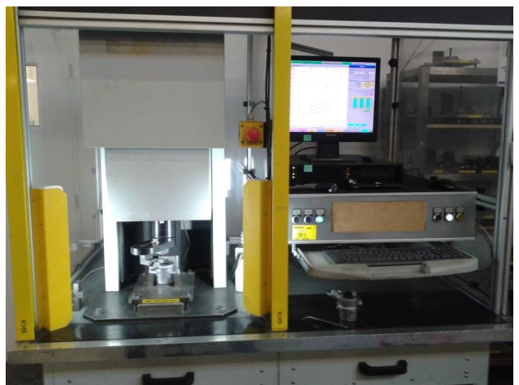
Obr. 8 Měřící stroj hystereze při měření
