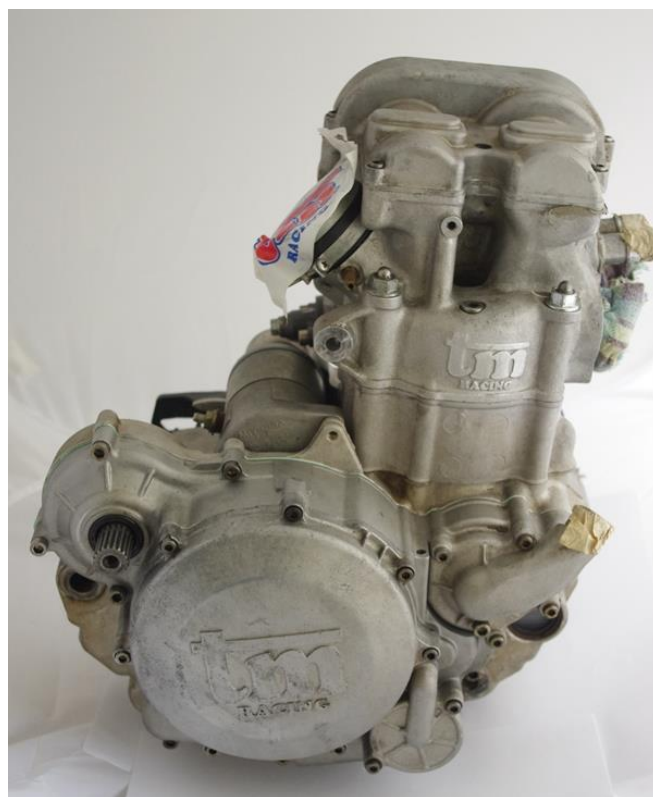
obr. 18 - motor motocyklu TM MX250F z roku 2006 (15)
