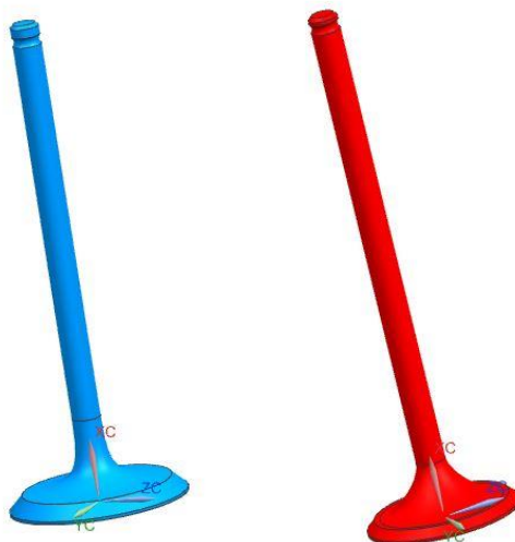
obr. 51 - Sací a výfukový ventil
