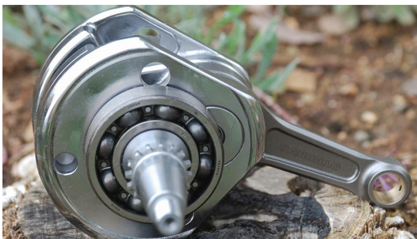
obr. 7 - klikový hřídel KX250F (5)
