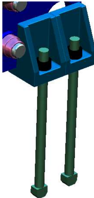
Obrázek 6.3: Ukotvení rámu do základů
