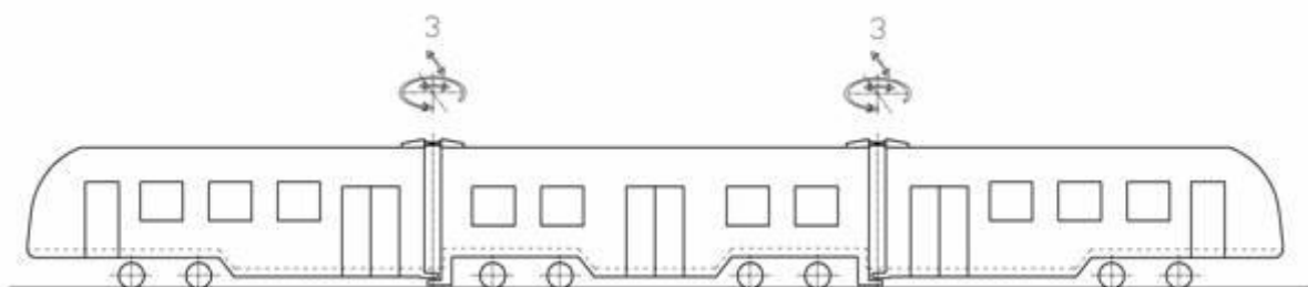
Obr. 9 Schéma tříčlávkové tramvaje se čtyřmi otočnými podvozky a dvěma klouby umožňující otáčení kolem vlastní osy a podélné i příčné kývání. [3]
