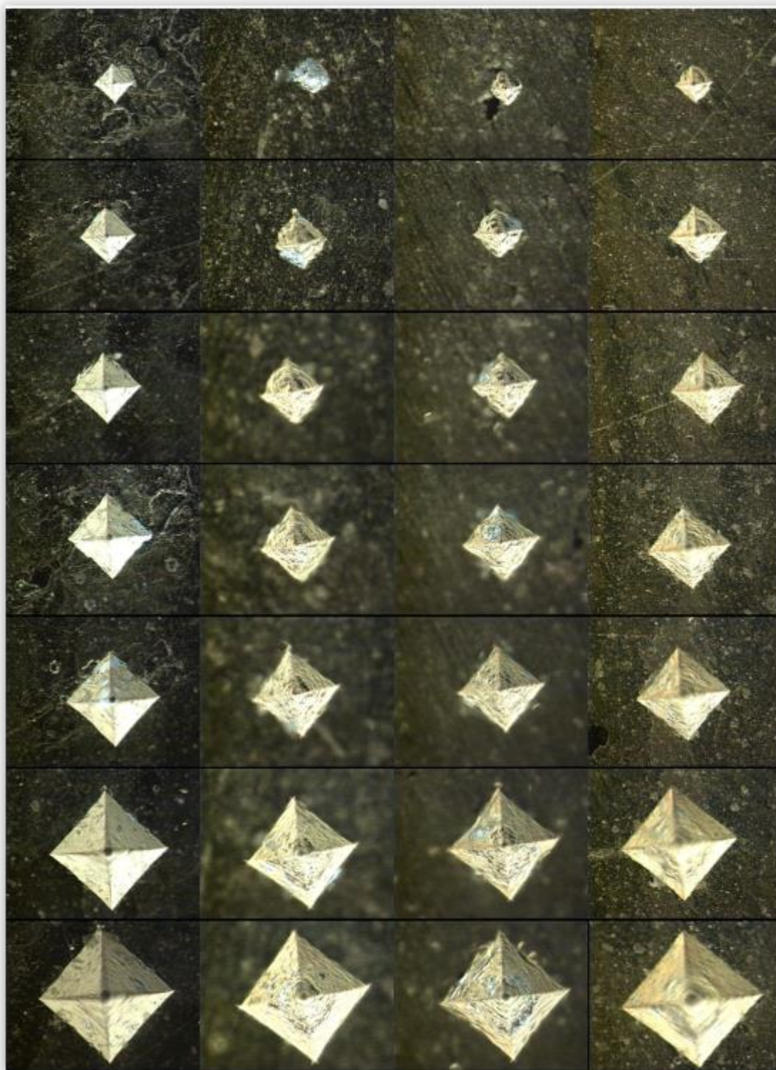
Obr. 72 - Morfologie vtisků vytvořených indentorem Vickers na vzorkách 1, 2, 3, a 4 (sloupce) s postupně rostoucí normálovou silou 20 N, 40 N, 60 N, 80 N, 100 N, 150 N a 200 N – dokumentováno ve tmavém poli.
