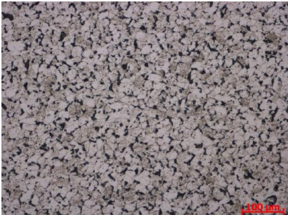
Obr. 59 - Snímek naleptané struktury vzorku se stupněm deformace 53,1 % z oceli S235JR-C při zvětšení 100x - poloha uprostřed.
