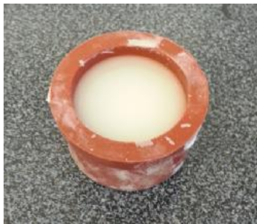
Obr. 26 - Vzorek zalitý v pryžové formě polymerovou směsí.
