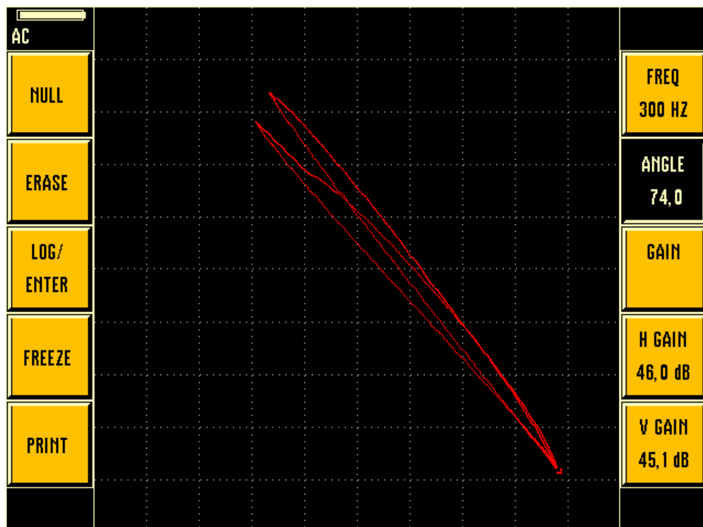
Obr. 42 - Porovnání vzájemné polohy koncových bodů nedeformovaného vzorku z hliníkové slitiny a vzorku se stupněm deformace 68 % 1. série.
