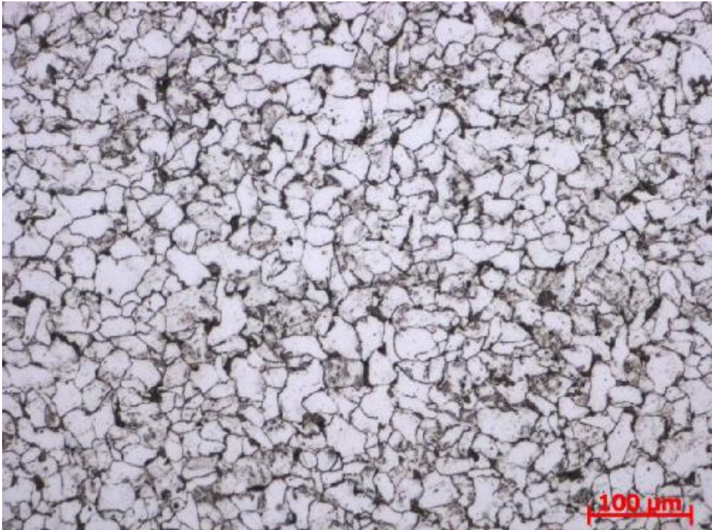
Obr. 58 - Snímek naleptané struktury vzorku se stupněm deformace 43,7 % z oceli S235JR-C při zvětšení 100x - poloha uprostřed.
