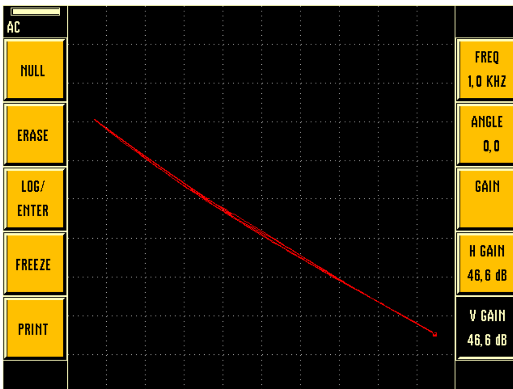
Obr. 51 - Poloha koncového bodu v impedanční rovině nedeformovaného vzorku z oceli S235JR-C.
