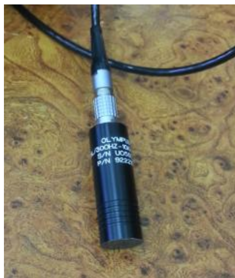
Obr. 30 - Absolutní sonda Olympus SL/300Hz-10kHz/0,62.
