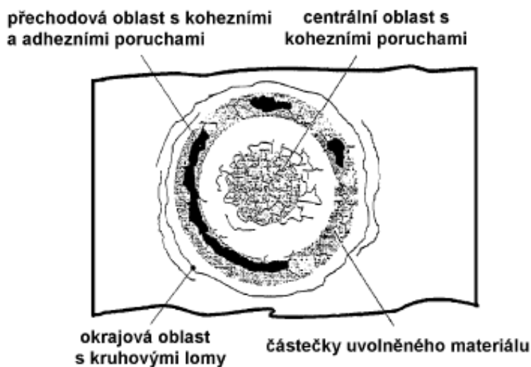
Obr. 32 Obvyklé degradační jevy v impact kráteru
