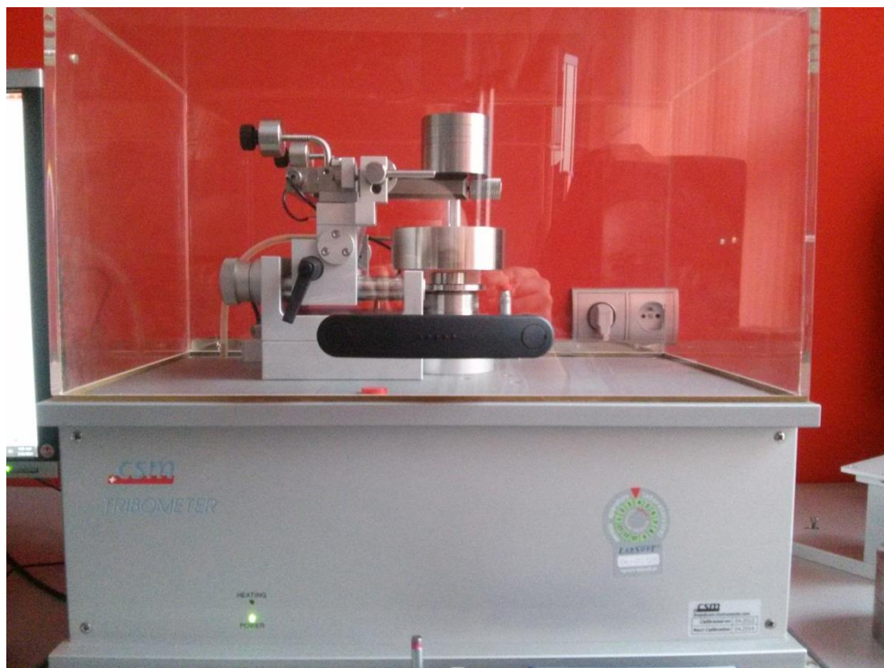
Obr. 3 Tribometr CSM Instruments v Polském institutu
