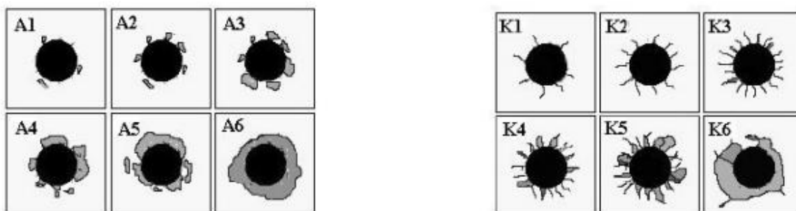
Obr. 5.2 Hodnocení porušení okolí vtisku vytvořeného Rockwellovým indentorem při zatížení 1 500 N [5]
