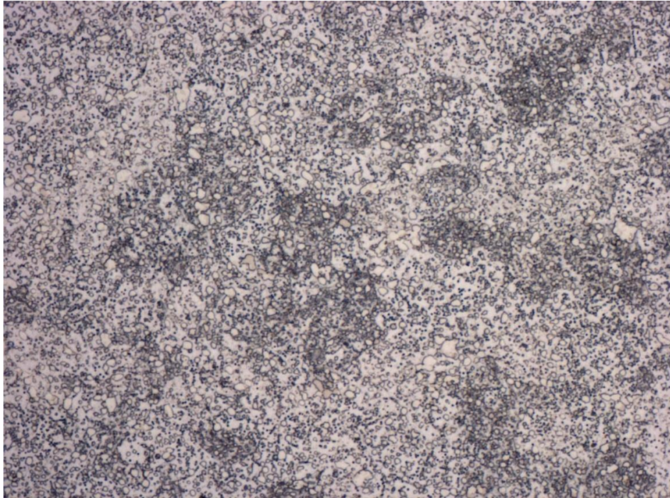
Obr. 7.7 Struktura globulárního perlitu oceli EN HS6-5-2+A
