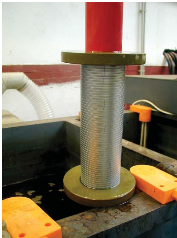
Obr. 10: Trn s pístními kroužky při chromování [25]
