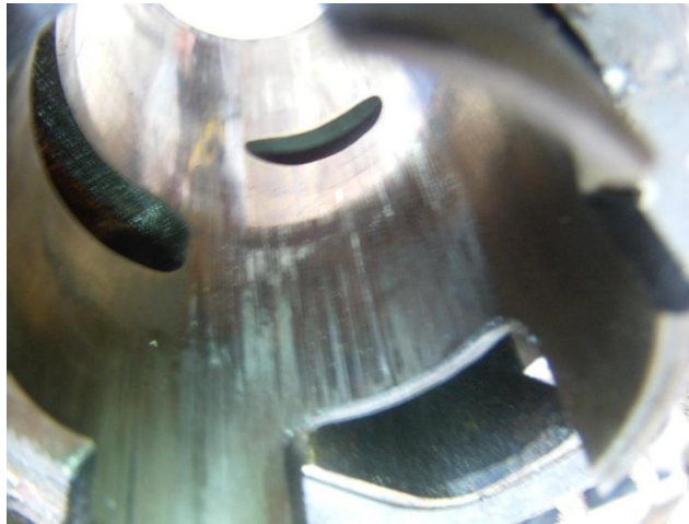
Obr. 8: Zadřený válec s drobným nanesením Al slitiny pocházející z pístu [26]
