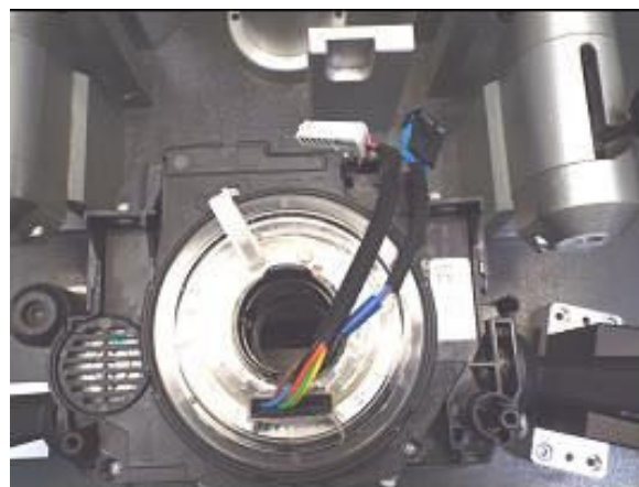
Obrázek 6.6 Špatná pozice kabelového svazku, při které vzniká poškození
