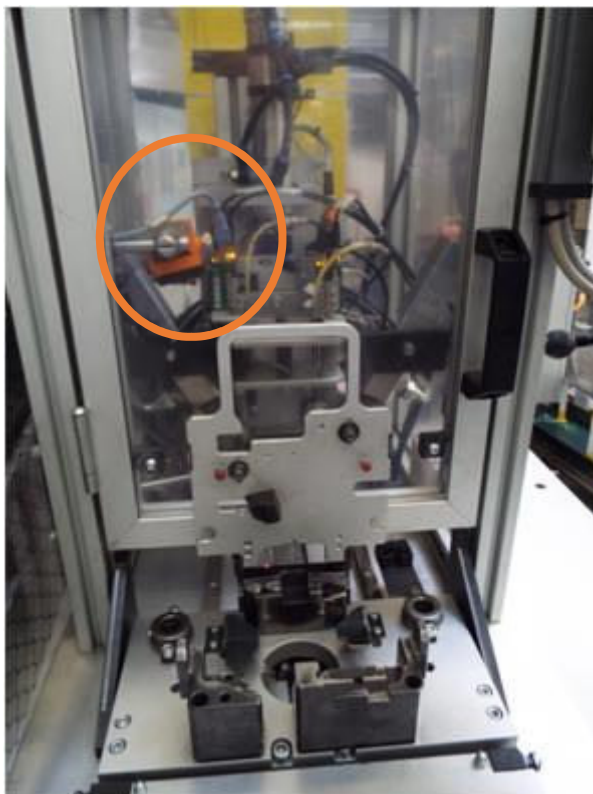
Obrázek 6.4 Senzor kontroly varianty soklu operace F020
