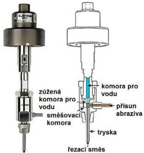
Obr. 26 - Řezací hlavice pro technologii AWJ [18]
