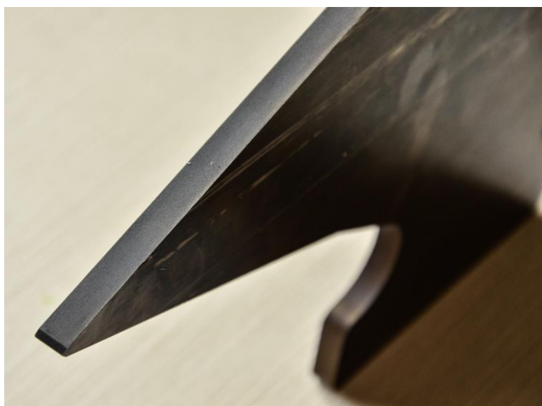
Obr. 43 - Stříhací nůž vyrobený drátovým řezáním – pohled 2
