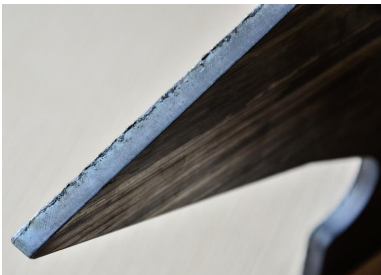
Obr. 46- Stříhací nůž vyrobený laserovým řezáním – pohled 2
