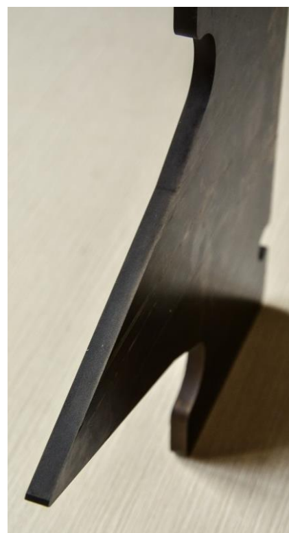
Obr. 44 - Stříhací nůž vyrobený drátovým řezáním – pohled 3
