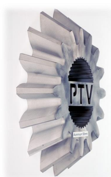
Obr. 31 - Ukázka výrobku technologií AWJ [20]
