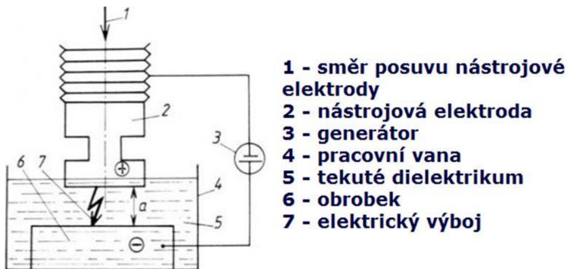
Obr. 2 - Princip zařízení pro elektroerozivní obrábění [2]
