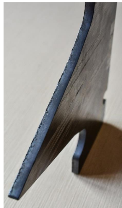
Obr. 47 - Stříhací nůž vyrobený laserovým řezáním – pohled 3
