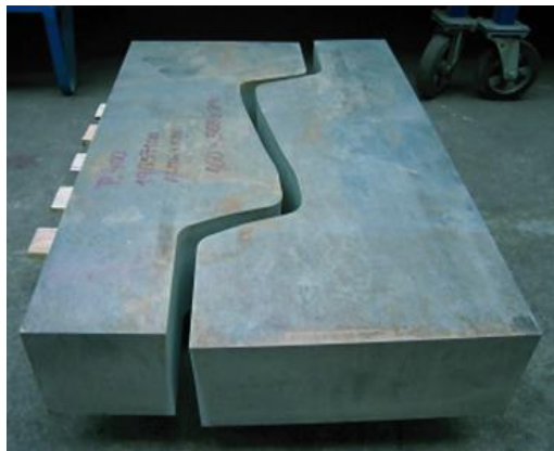
Obr. 27 - Řez duralu tloušťky 160mm
