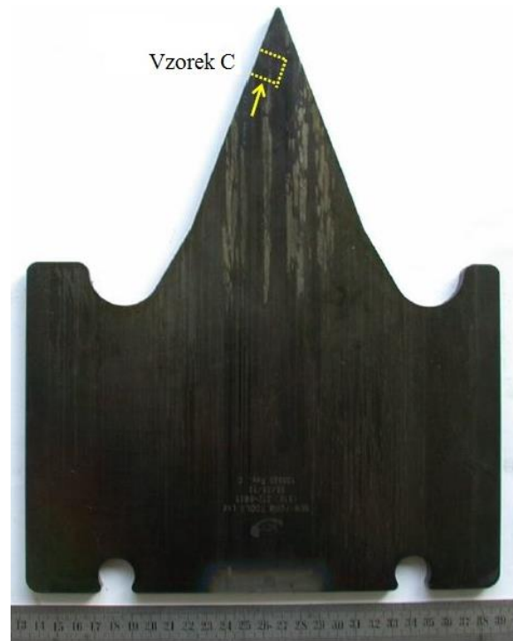
Obr. 55 - Nůž po elektroerozivním řezání [32]
