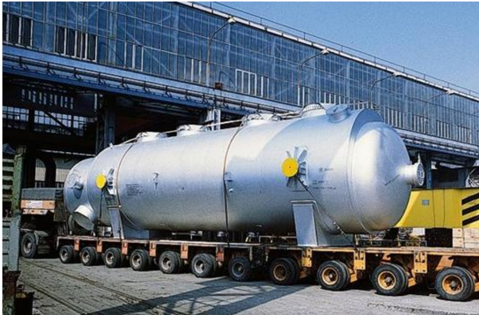
Obrázek 6 – Expedice ohříváku topné vody na stavbu [10]
