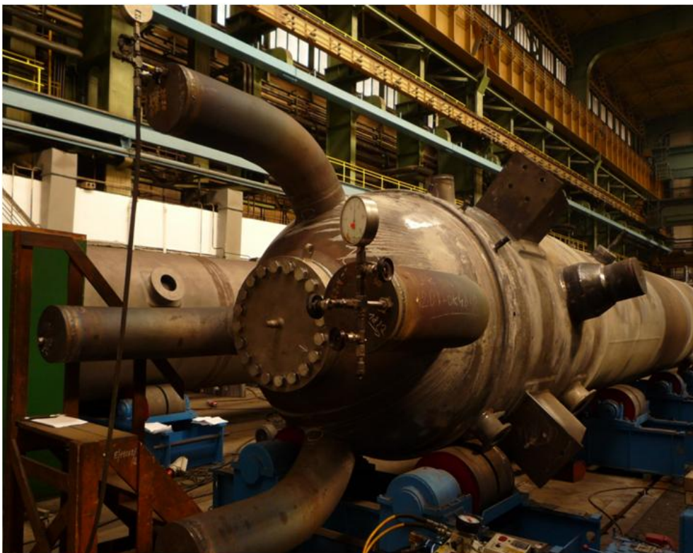
Obrázek 14 – Tlaková zkouška VT ohříváku [10]
