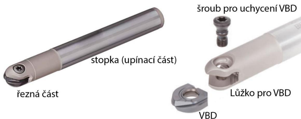
Obrázek 24 – části kulové frézy [9]
