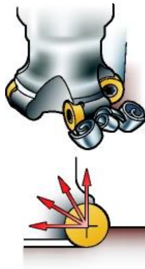
Obrázek 17 – úhel nastavení u fréz s kruhovým břitem [5]
