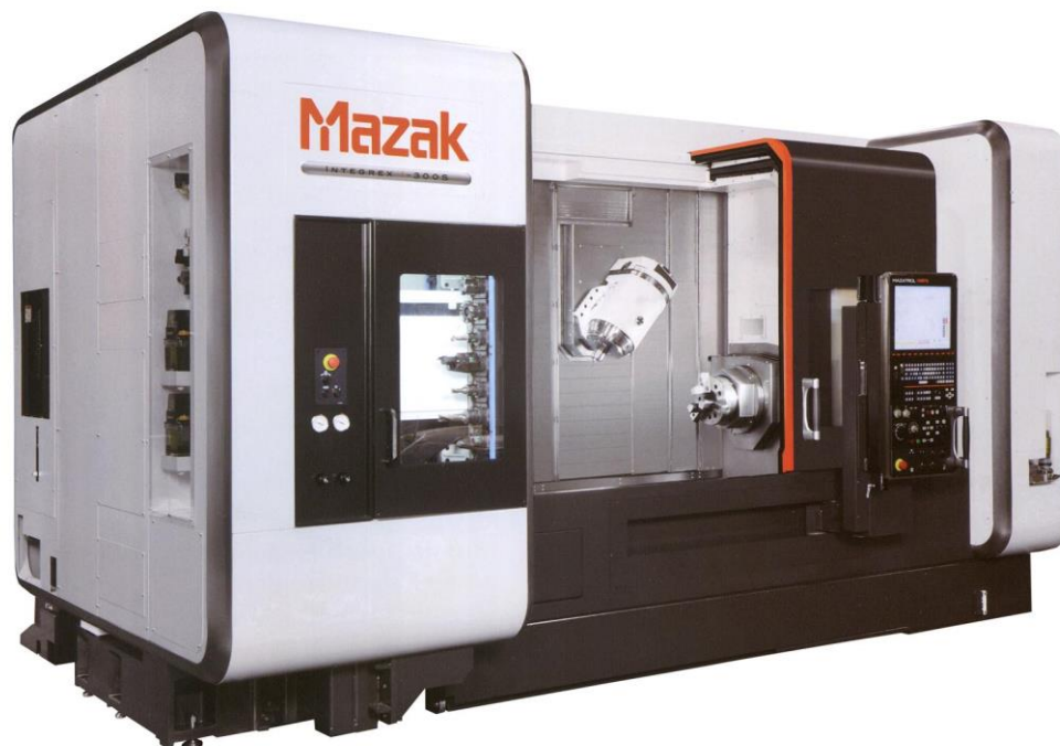
Obrázek 42 – Multifunkční obráběcí centrum Yamazaki Mazak Integrex j300/400 [11]
