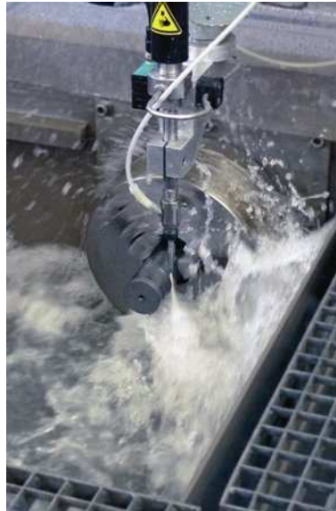
obr. 19 - soustružení abrazivním kapalinovým paprskem[11]
