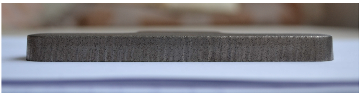
obr. 29- vznik úkosu u plasmové technologie
