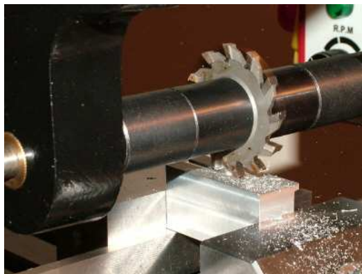
obr.3 – dělení materiálu kotoučovou frézou
