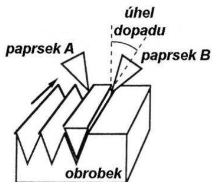
obr. 15. frézování laserem - malý úhel dopadu paprsku laseru[3]
