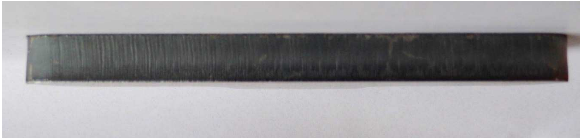
obr. 30- vznik úkosu u laserové technologie
