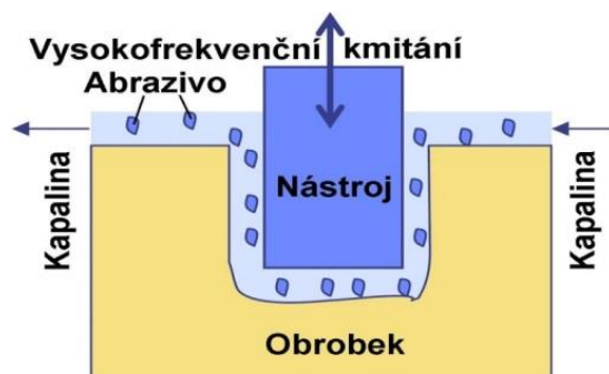
Obrázek 11: Princip ultrazvukového obrábění [2]
