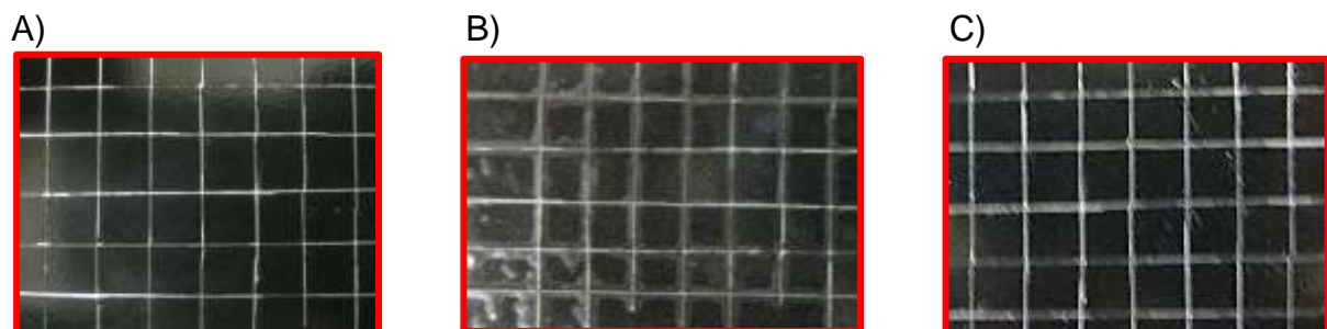
Obr. 12: A) Připravený vzorek, B) přilepení samolepicí pásky a vyhlazení, C) výsledek zkoušky
