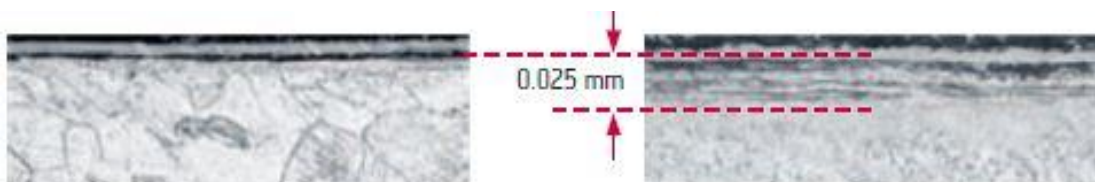
Obr. 23 Rozdíl mezi novým vrtákem a opotřebeným při ovlivnění povrchové vrstvy [79]
