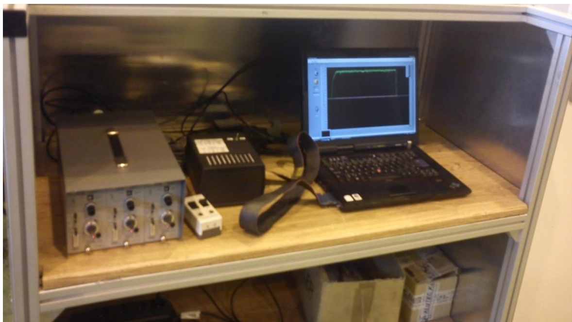
Obr. 41 Soustava pro měření řezných sil a momentů
