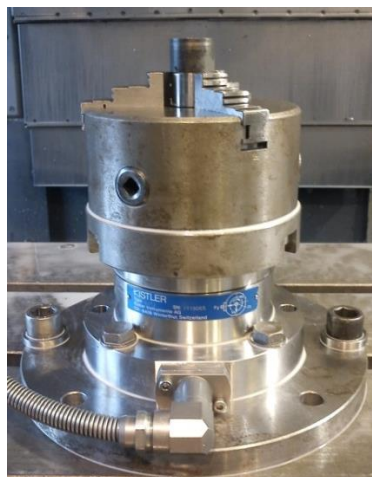
Obr. 39 Dynamometr se sklíčidlem a vzorkem
