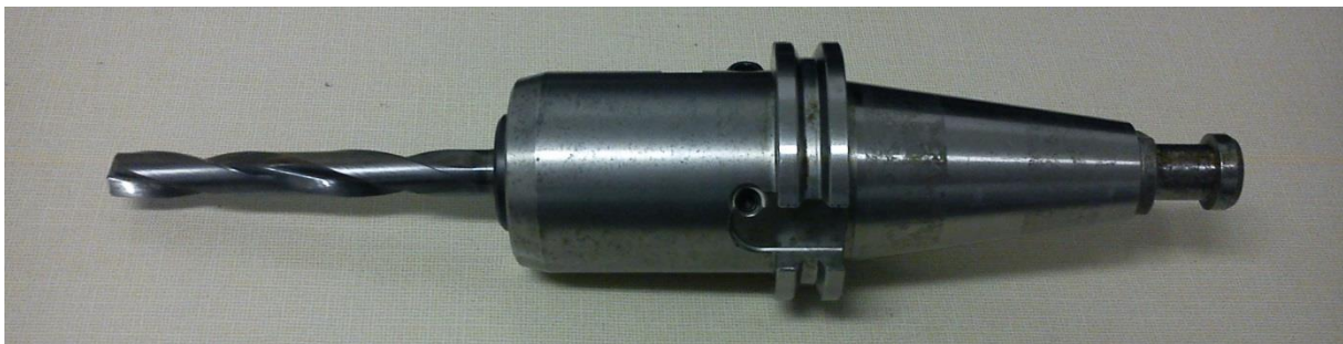
Obr. 35 Upnutí vrtáků do hydraulického upínače
