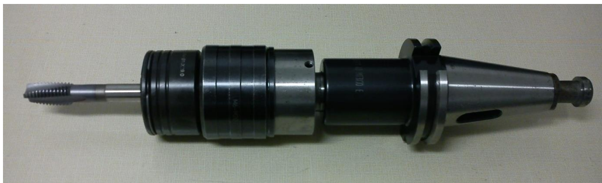
Obr. 36 Upínání závitníků – vyrovnávací hlava
