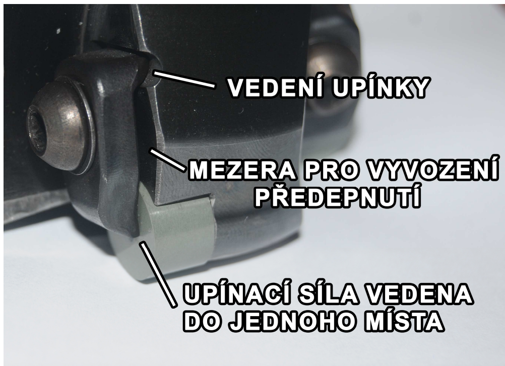
Obrázek 13: Konstrukční prvky upínky od firmy SANDVIK COROMANT
