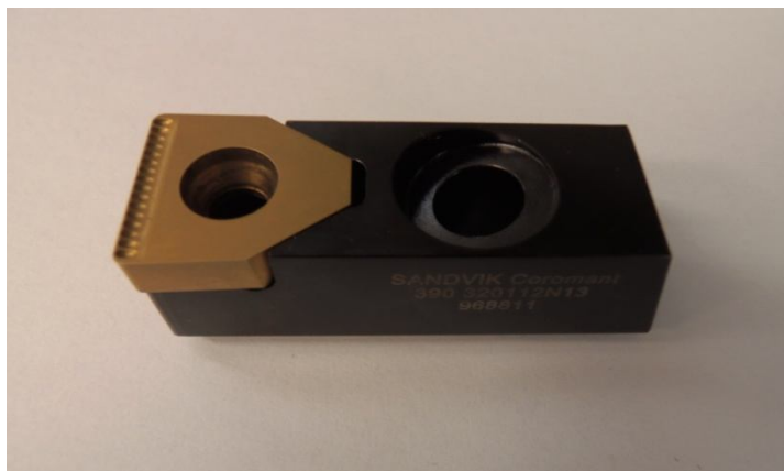
Obr. 2-2 Zapichovací kazeta s vyměnitelnou břitovou destičkou firmy Sandvik
