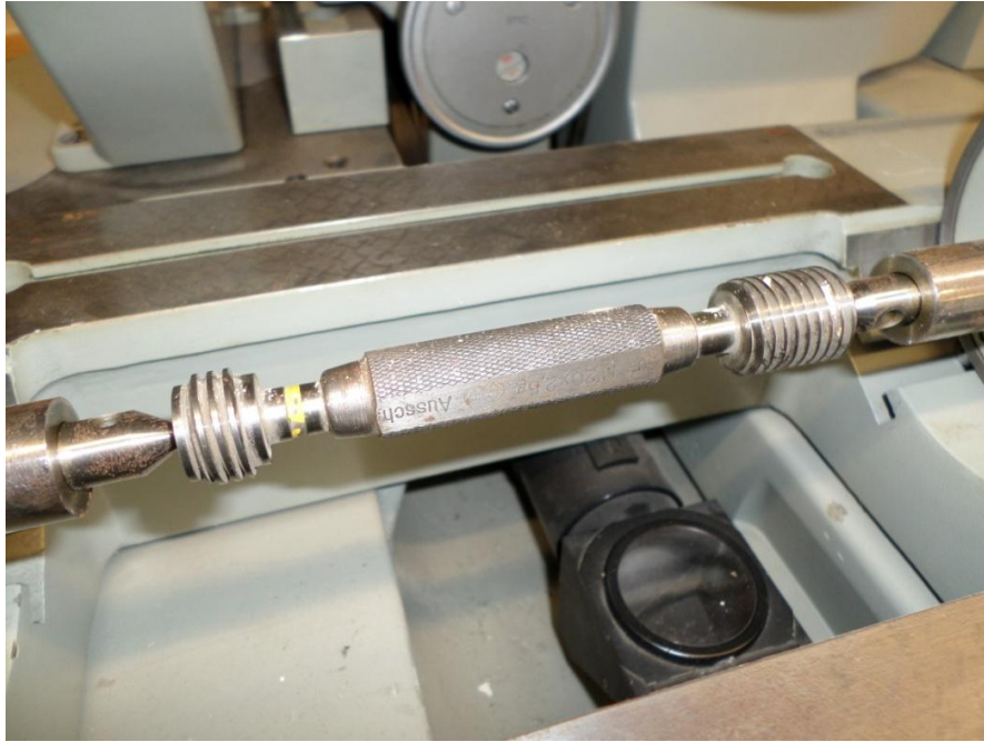
Obrázek 37 ukázka upnutí na mikroskopu pro měření závitu
