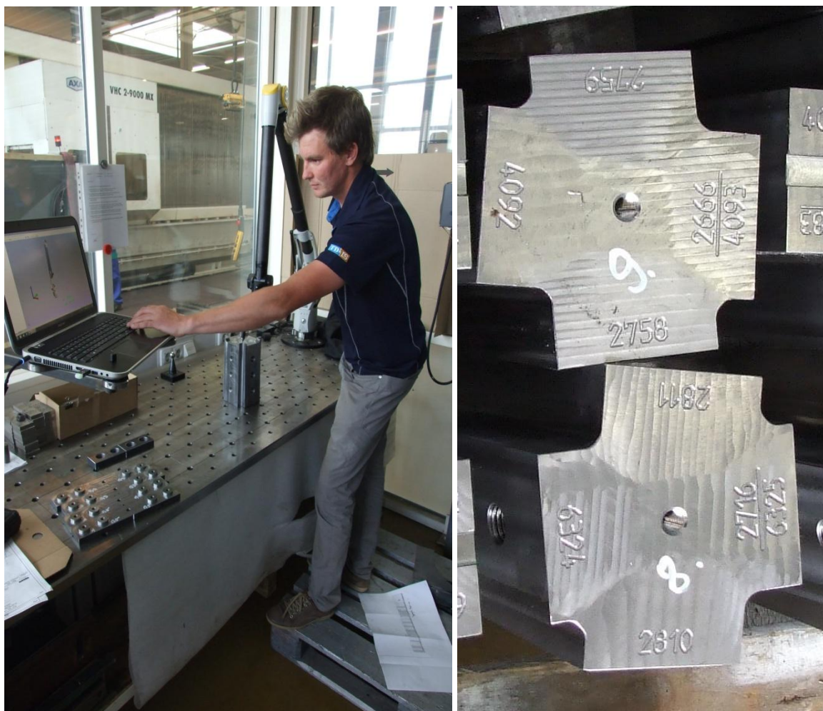
Obrázek 12 Ukázka měření a značení hvězd pro metodu průměru a rozpětí ve společnosti seele pilsen s.r.o
