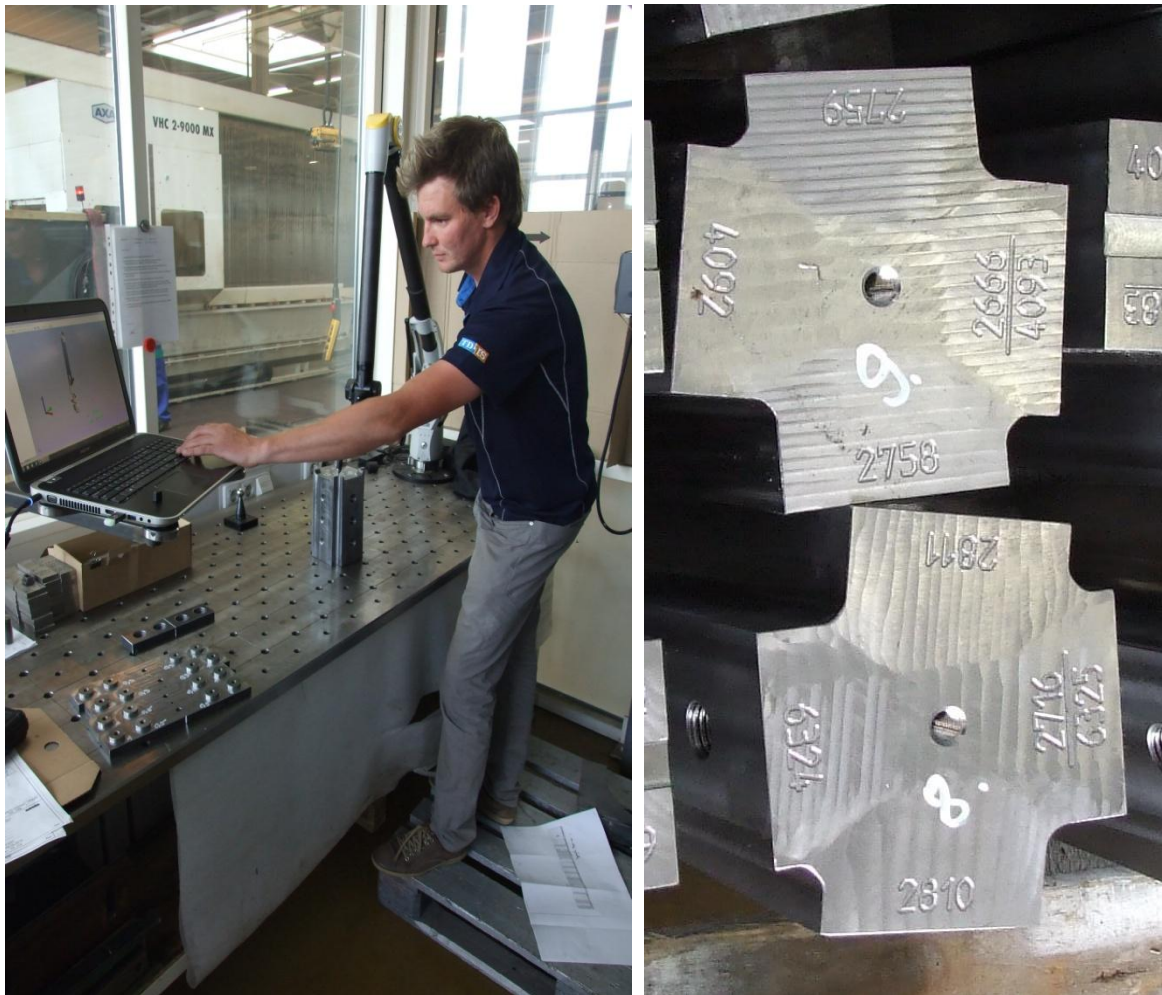
Obrázek 18 Ukázka měření a značení hvězd pro metodu průměru a rozpětí ve společnosti seele pilsen s.r.o
