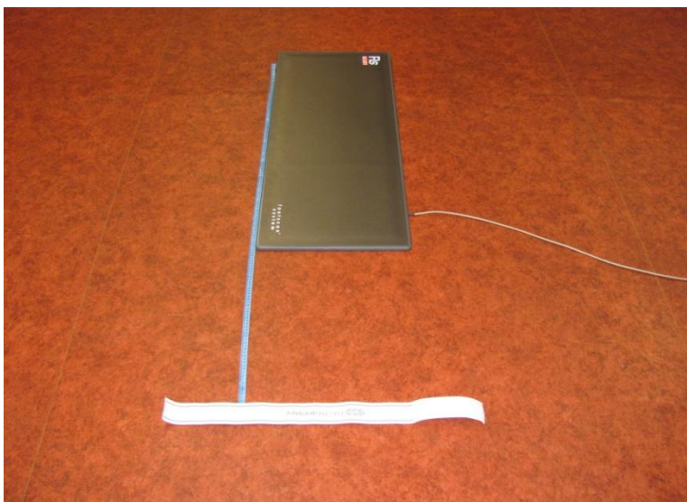
Obrázek 4 Nastavení vzdálenosti půl kroku před nášlapnou deskou
