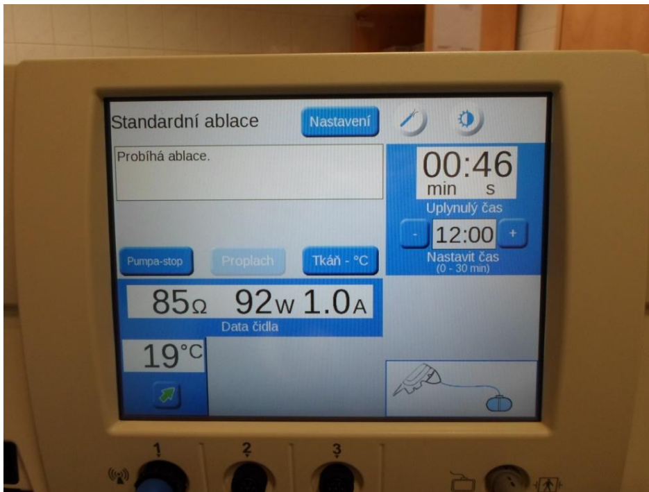
Obrázek 68: Obrazovka na přístroji pro RFA. Nastavené parametry- odpor, výkon, proud, odpočet času
