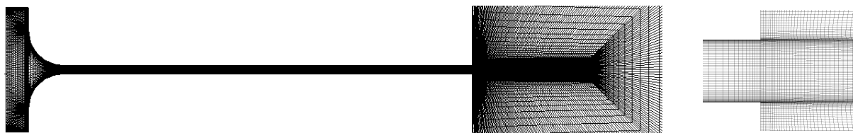
Obr. 4.40: Detail výpočetní sítě o 31736 elementech. Detail mezery (vlevo), detail výstupu z mezery (vpravo).
