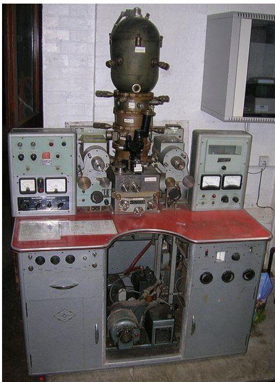
Obr. 2.38 Přístroj Microscan firmy Cambridge Scientific Instrument Company označovaný jako EPMA, EMPA či mikrosonda ve sbírkách Cambridge Museum of Technology [14].
