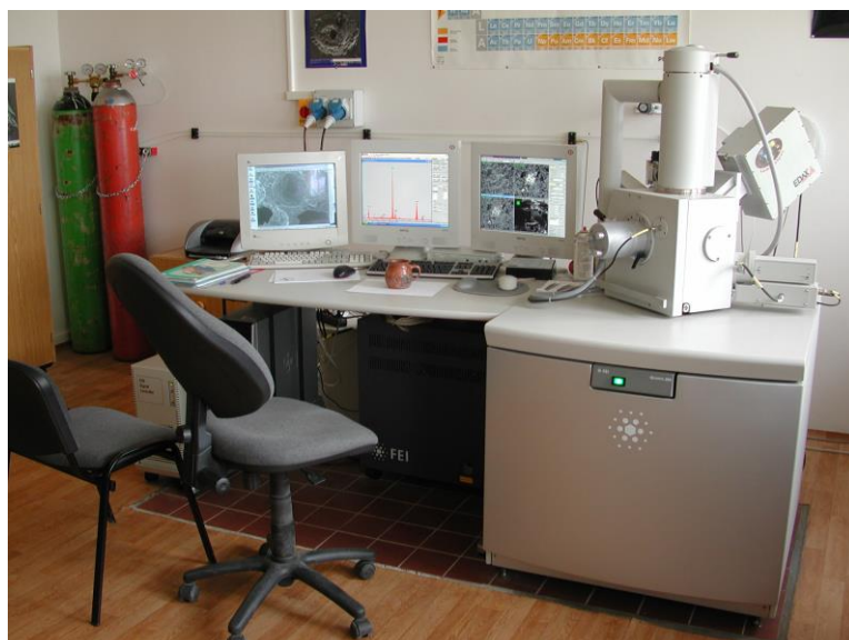
Obr. 4.1.1 Skenovací elektronový mikroskop FEI Quanta 200 s detektory EDS a WDS od firmy EDAX.
