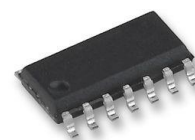
Obrázek 11: SOIC14 pouzdro mikroprocesoru.
