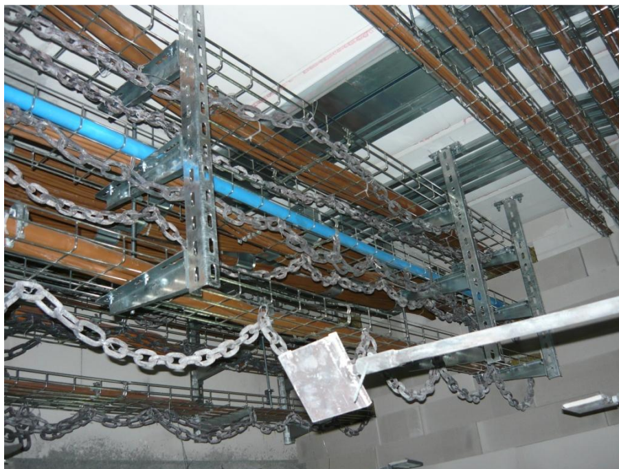
Obr. A-4: Pohled na vzorky ve zkušební komoře před zkouškou; trasy M4 až M6 zatížené ocelovými řetězy
