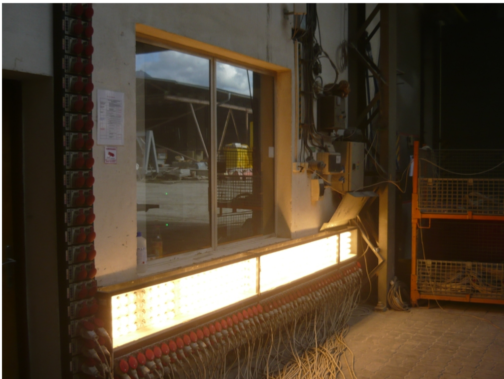
Obr. A-9: Pohled na velín a připojené kontrolní žárovky ke každé zkoušené trase (30 min od začátku zkoušky)
