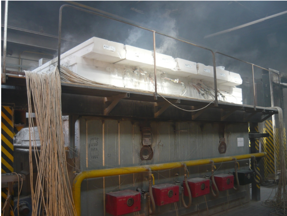
Obr. A-8: Zkušební komora zvenku přibližně po třiceti minutách zkoušky
