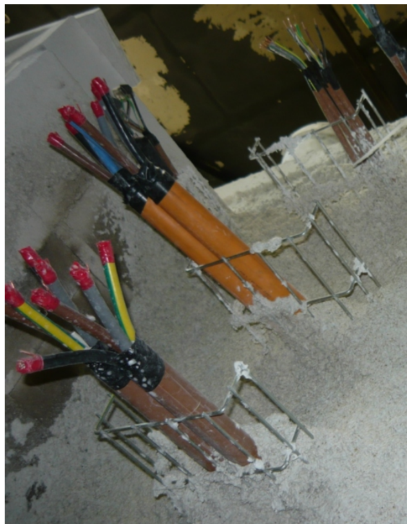
Obr. A-6: Prostupy kabelů skrz stěnu zkušební komory – foceně zvenku komory – trasy M7 až M9
