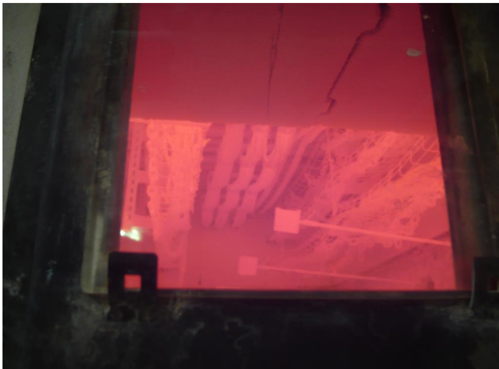
Obr. A-10: Pohled skrz kontrolní okénko do zkušební komory ve třicáté minutě zkoušky
