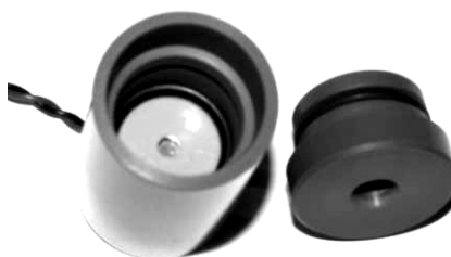
Obr. 39: Prototyp jednoduchého kalibrátoru měřících mikrofonů s tlakovou komorou buzenou piezodestíčkou Kiocera KBS-20DB-4P-0 a adaptérem pro testování ECM mikrofonních vložek. Zdroj: vlastní.
