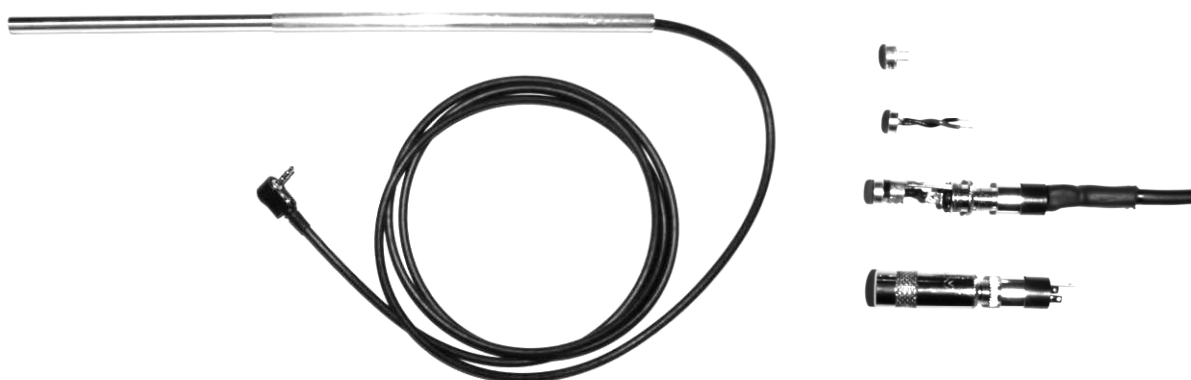
Obr. 31: Mikrofonní vložka vestavěná do hliníkové trubičky s měřicím kabelem a konektorem (vlevo) a vestavba mikrofonní vložky do pouzdra sluchátkového konektoru TRS 3,5 mm. Zdroj: vlastní
