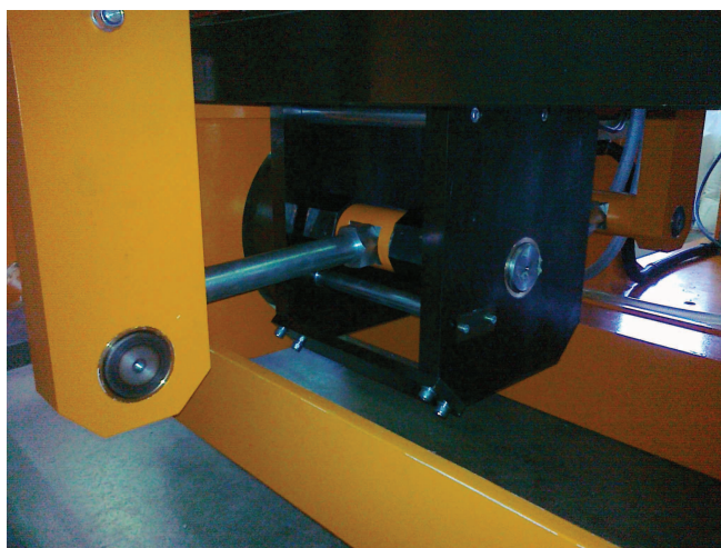
Obr. 9.2–2 Klikový mechanismus zavírání forem
