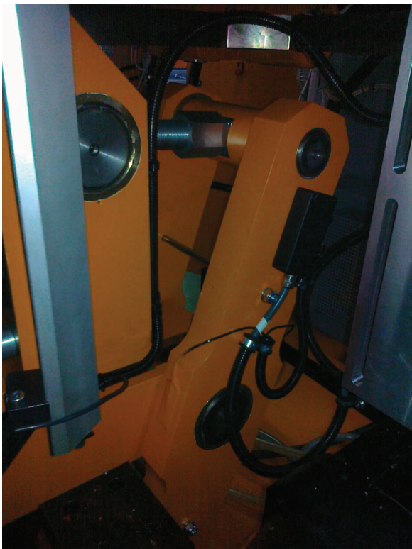
Obr. 9.2–1 Páky mechanismu zavírání forem včetně páru tenzometrů pro stanovení síly
