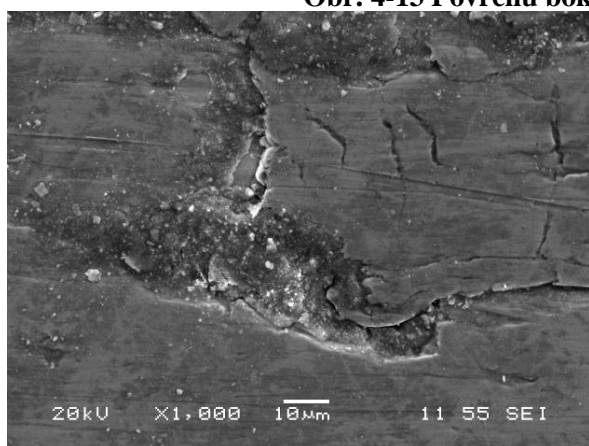
Obr. 4-14 Povrchu boku zubu, zvětšení 1000x [29]
