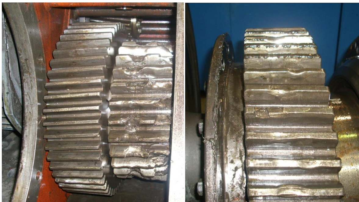
Obr. 0-1 – Poškozené ozubení v převodovce elektrické jednotky 471 [29]
