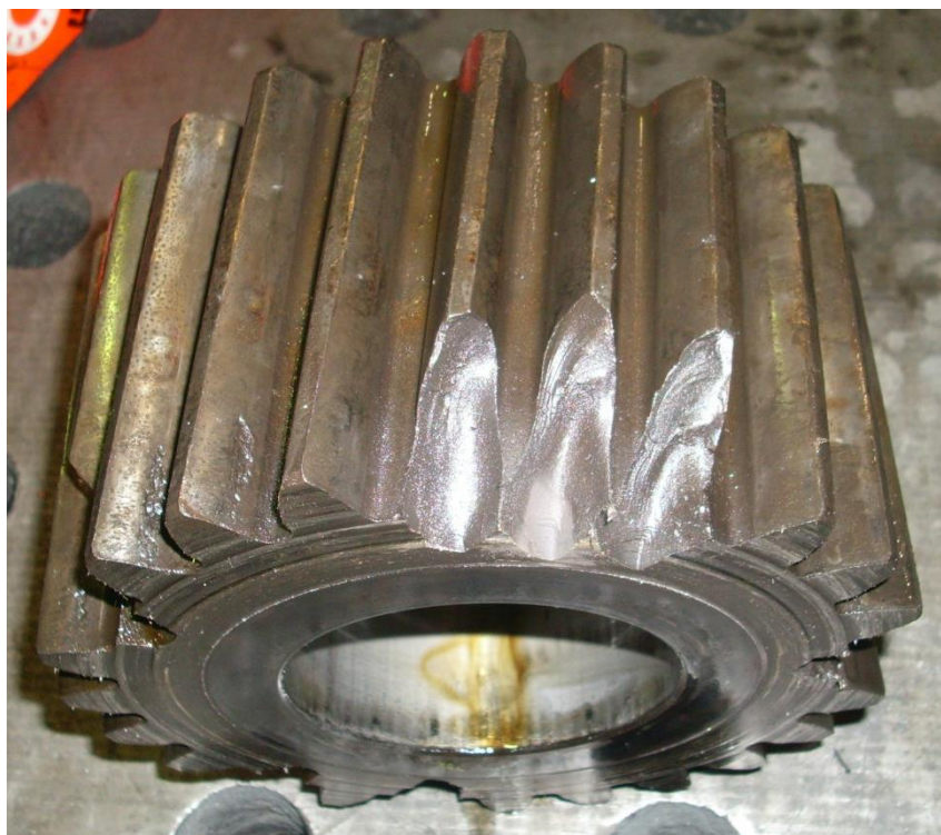
Obr. 4-2 Poškozený pastorek po demontáži z převodovky [29]
