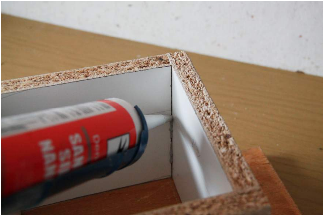
11.6 Obrázek 4 tmelení spár
