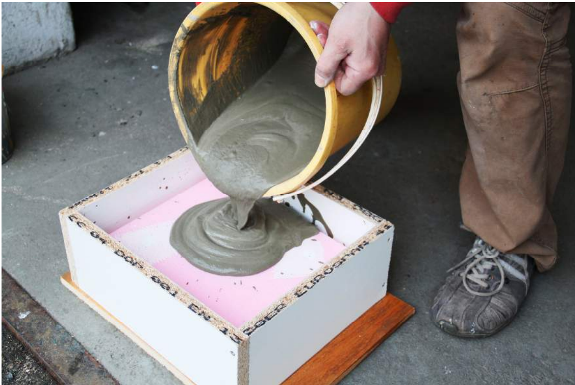
11.6 Obrázek 7 lití betonu
