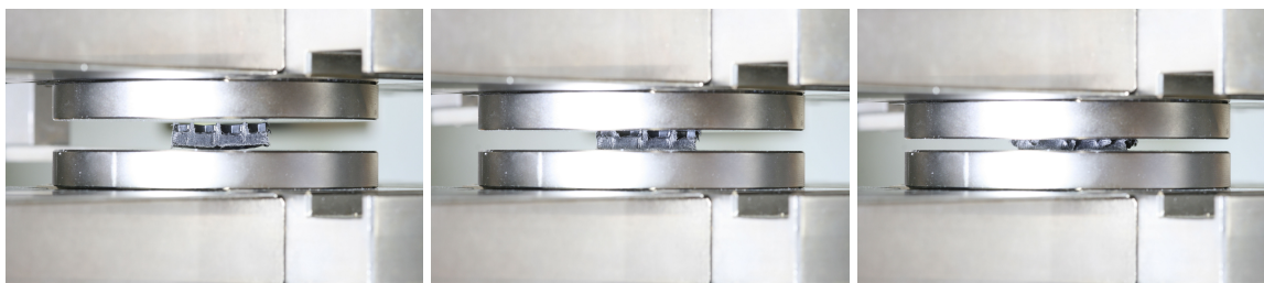
Obrázek 2: Tlaková zkouška plastového vzorku se strukturou honeycomb
