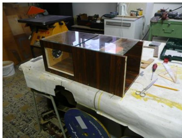
Obrázek 11. Příprava skel na horní části tunelu
