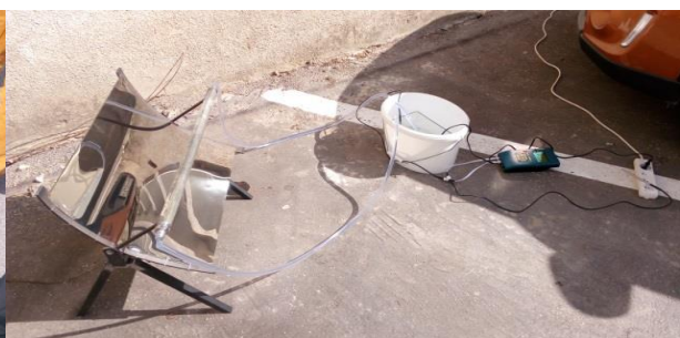
Obrázok 6. Meranie ohrevu vody
