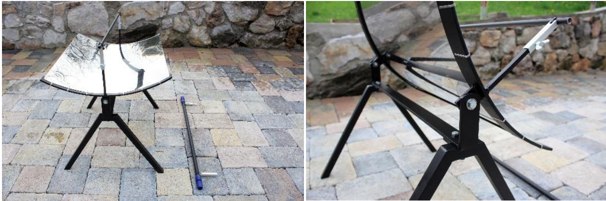
Obrázok 4. Lineárny parabolický slnečný kolektor
