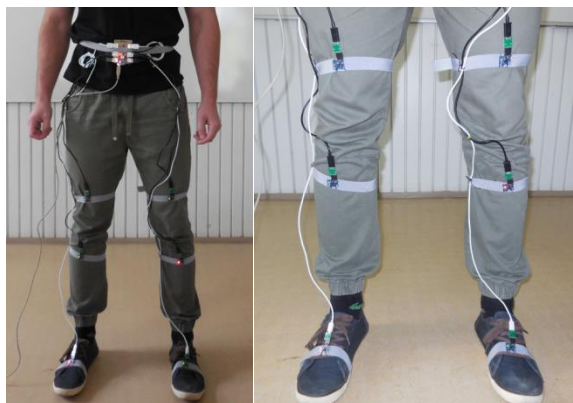
Obr. 3: Umiestnenie prvkov systému pre snímanie a zber dát zo snímacích modulov GY-521 na segmentoch dolných končatín
