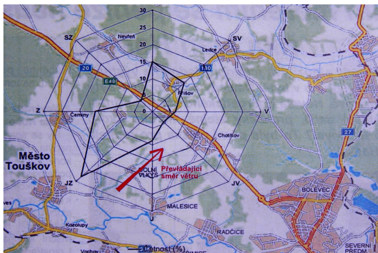
Bild 1 – Windstern auf der Karte im Gebiet des geplanten Aufbaues im Chotíkov bei Pilsen [1]
