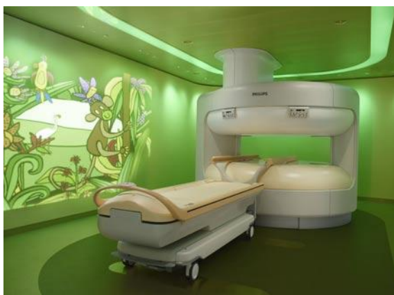
Obr. 5-7 "otevřená" konstrukce Philips Panorama HFO [17]
