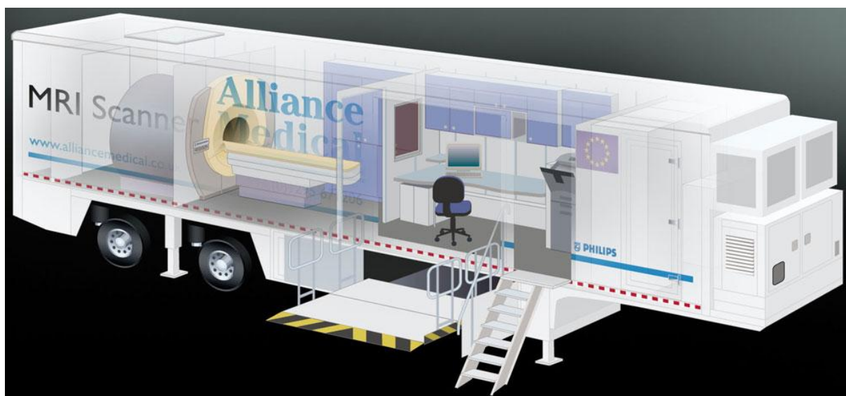
Obr. 5-9 Schéma zařízení Philips Achieva Mobile MRI [17]
