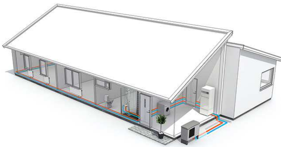
Obr. 6 Venkovní instalace výparníku [Zdroj: TERMO s.r.o.].
